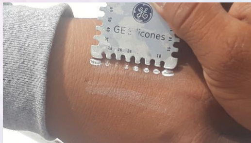
Espesor en fresco de 28 mils / 0.71 mm.
