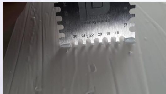
Medición de espesores en fresco
