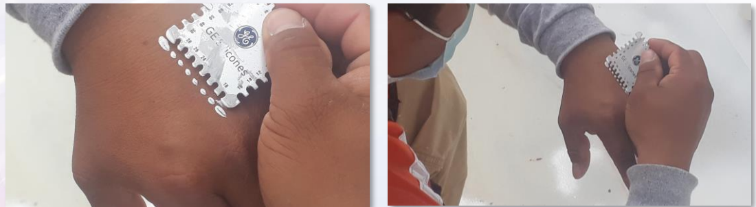
Medición de espesores en fresco
